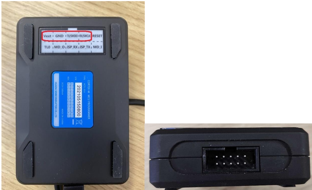
図 4 プログラマ背面の端子名説明と側面の端子
