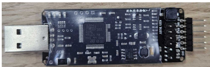
図 3 プログラマ(PCB タイプ) 型番 HDSC-CCID-PCB
