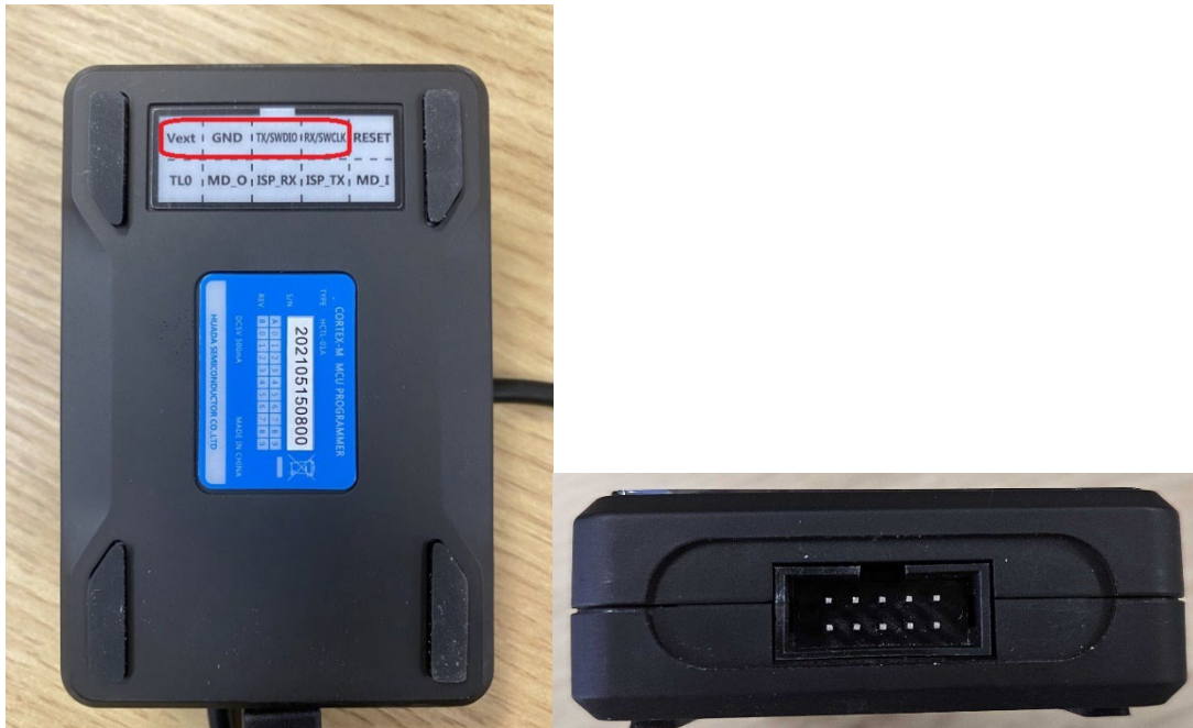
図 5 プログラマ背面の端子名説明と側面の端子
