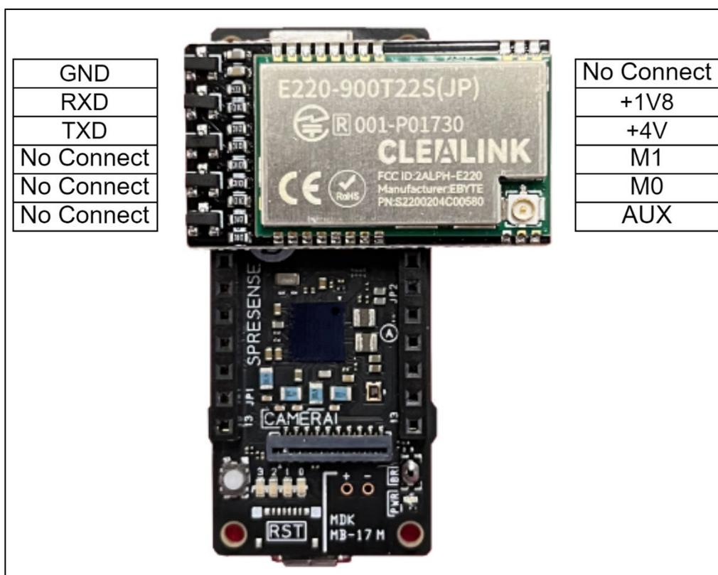
図 1 LoRa Add-on ボード ピン情報
